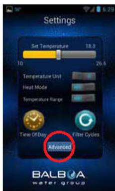
L'écran des réglages vous permet de choisir la température du spa, de changer la température de Fahrenheit à Celsius et vice-versa, de régler l'heure du jour, les cycles de filtrage et plus.
